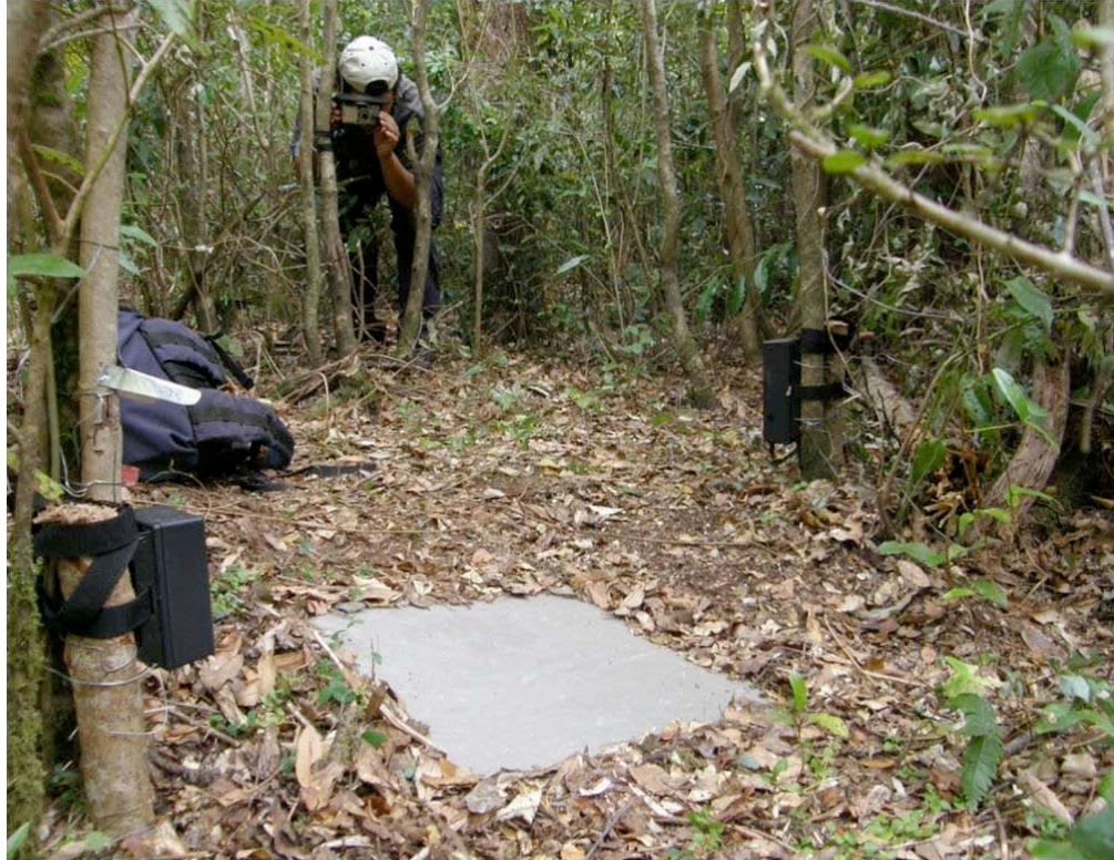
Figura 2. Equipos de detección activa en terreno. Se observan la cámara trampa (superior), emisor (izquierda), receptor (derecha) y cebo olfativo (sobre emisor).
